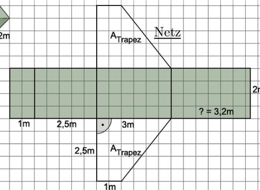
Klappt man alle Seitenflächen eines Körpers in eine Ebene auseinander, so erhält man ein **Netz des Körpers**. Daraus können z. B. fehlende Seitenlängen gemessen und der **Oberflächeninhalt O** des Körpers gut berechnet werden:
