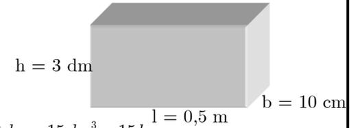
Bsp.:  $V_Q = 0,5 m \cdot 10 cm \cdot 3 dm = 5 dm \cdot 1 dm \cdot 3 dm = 15 dm^3 = 15 l$
