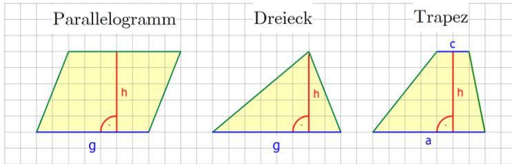
Parallelogrammflächeninhalt = Grundseite mal Höhe:  $A_{\text{Parallelogramm}} = g \cdot h$
